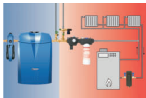
AQA therm von BWT verhindert Kalkausfällungen, Schlamm und Luft in der Heizungsanlage.
