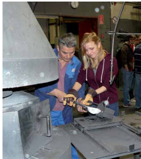
Studentin beim Gießen einer Armatur.
